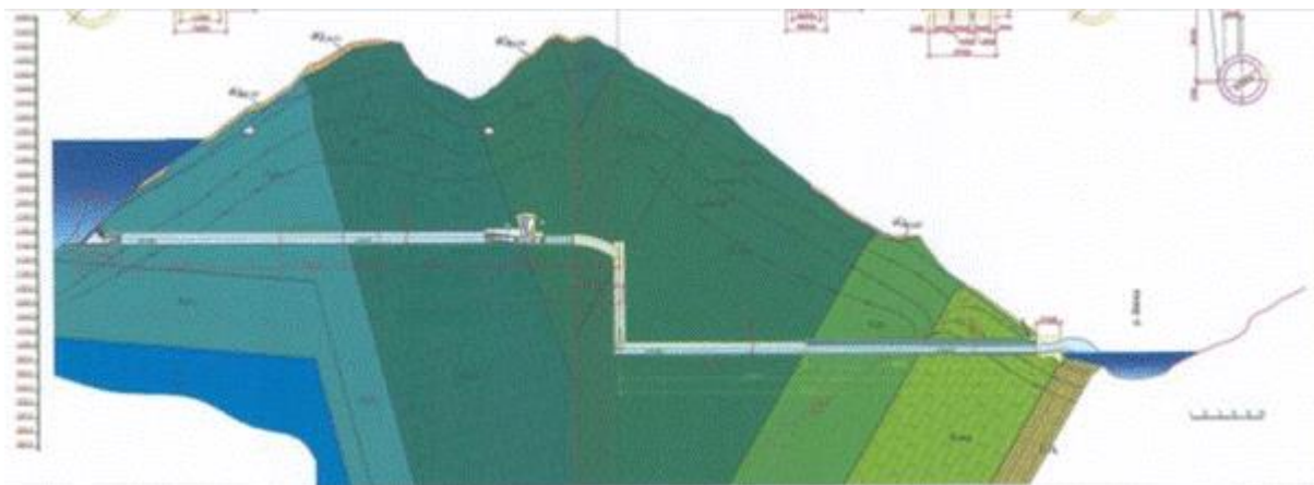
Рис. 3-1 : Выборка из исследования ИГП - 3-ий эксплуатационный водосброс - продольное сечение
