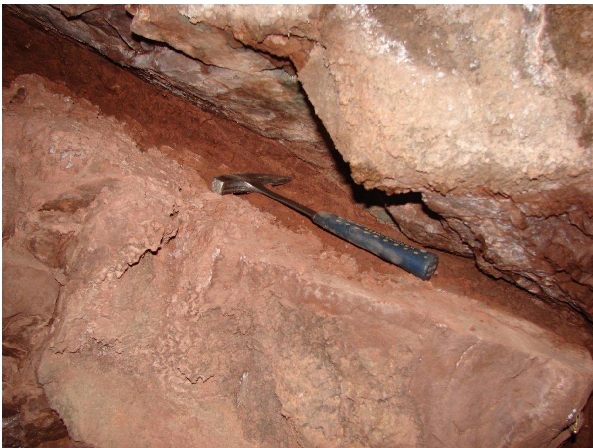
Рисунок 0.7: Разлом (трещина?), похожая по падению азимута на разлом № 35, примерно с 50 мм заполнения чистой пластичной глиной (изыскательная штольня 1002, ниже разлома №35)
