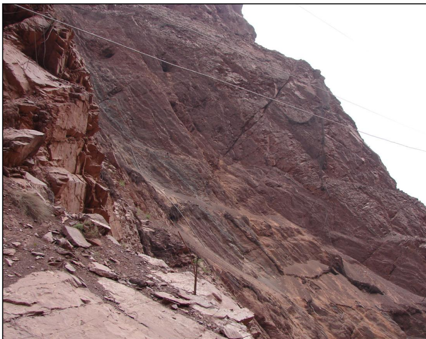
Рисунок 0.8: Разлом с похожим залеганием, как и разлом №35, падающий в сторону верхнего бьефа, прорезающий алевролиты Нижнего Обигарма и песчаники Верхнего Обигарма; На заднем фоне: другие трещины принадлежащие той же системе четко видны (направление залегания круто падающего в сторону верхнего бьефа)
