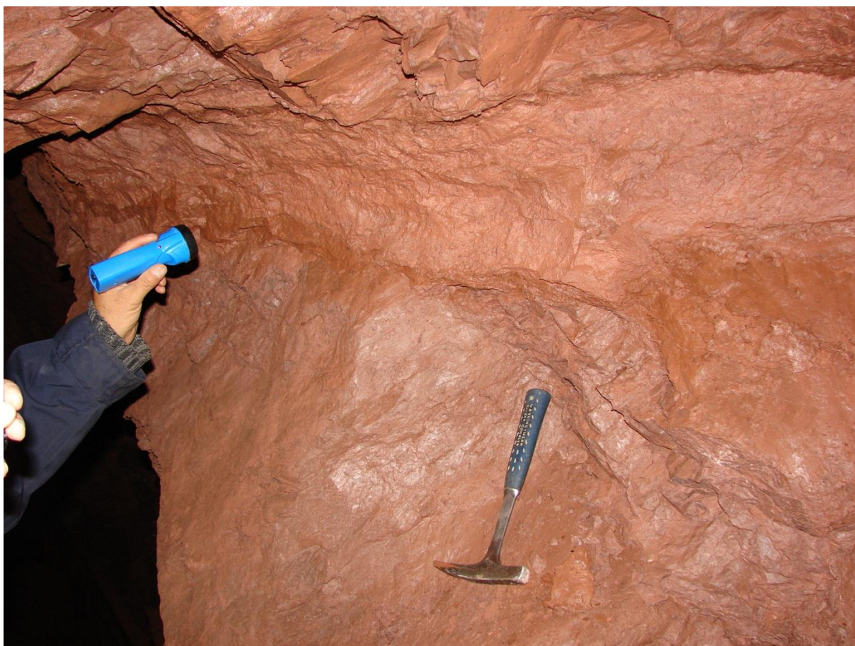
Рисунок 0.9: Вид породы, чуть выше северного ответвления разлома №35; мелкозернистая глина присутствует вдоль большинства трещин (галерея 1002)
