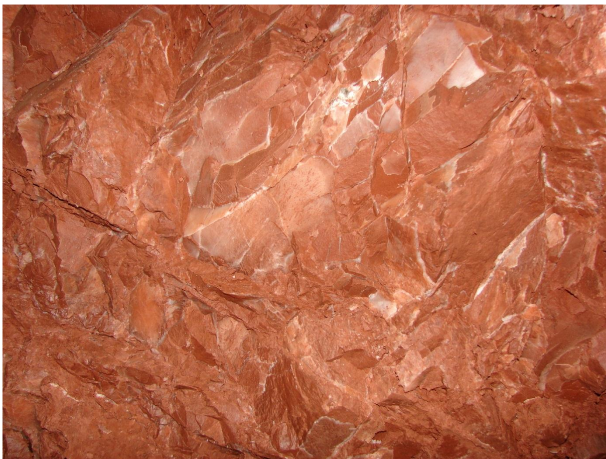
Рисунок 0.3: Вид крупным планом Гаурдакского алевролита, якобы систематический, мелкий гип покрывающий разрывы (штольня 1034)
