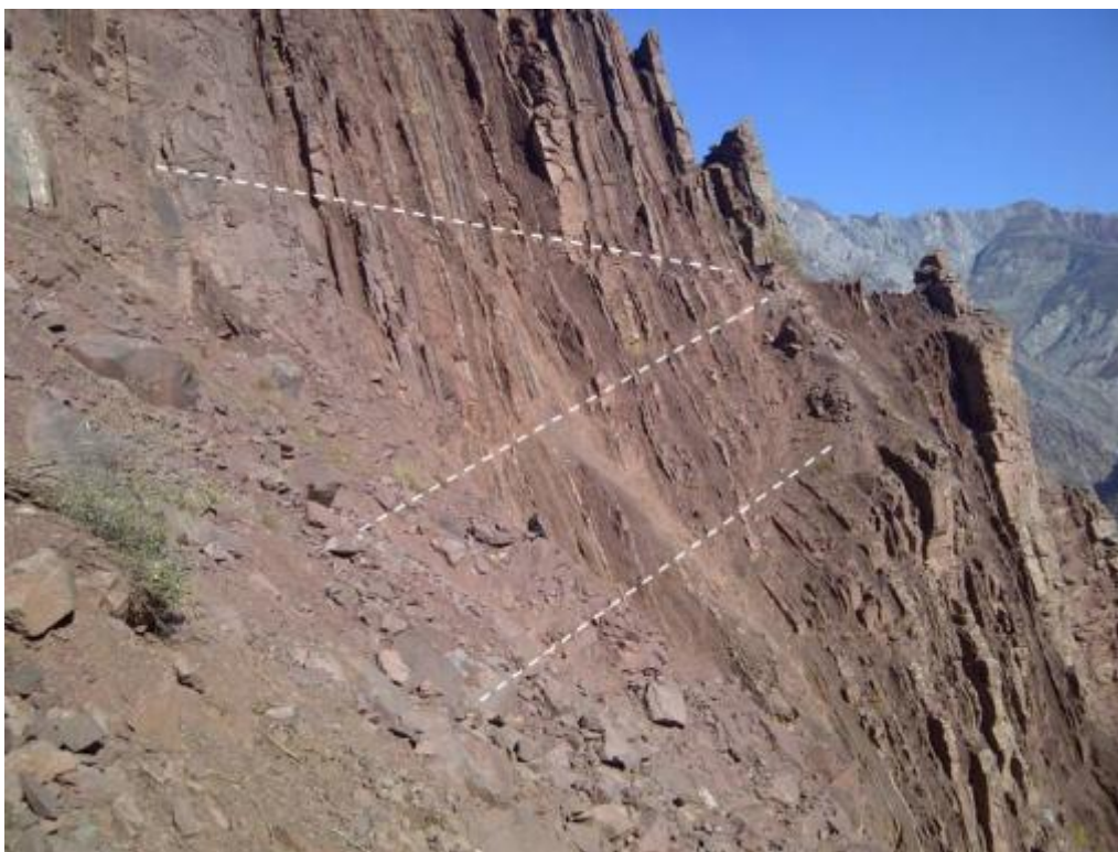
Рисунок 27. Смещения по субгоризонтали и разрывы S4, верхняя часть горы нижнего бьефа около границы атипичной зоны.
