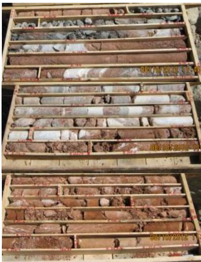
Рисунок 18. Йонахшский разлом в скважине WRB2
