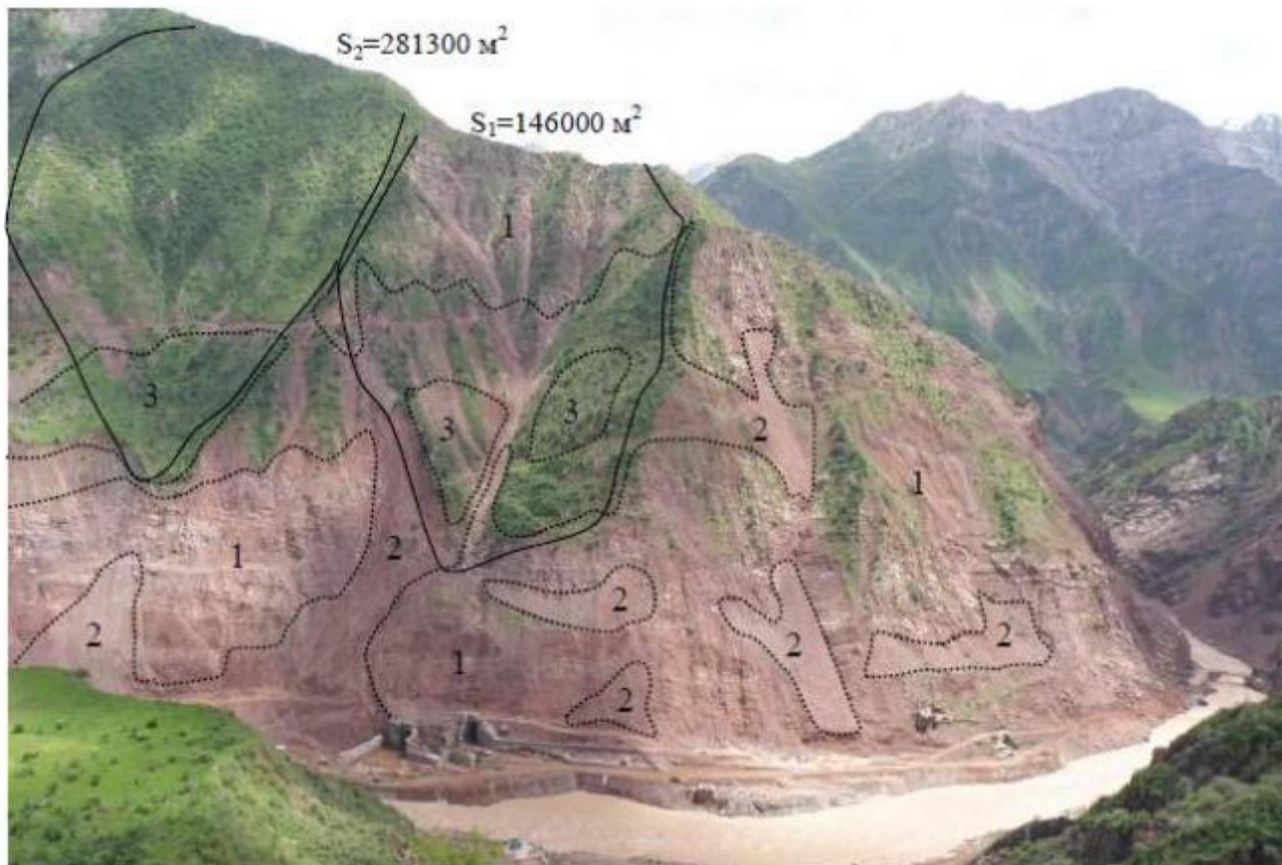
Рисунок 30. Накопление толстых отложений на склоне (3) на левом берегу верхнего бьефа.
