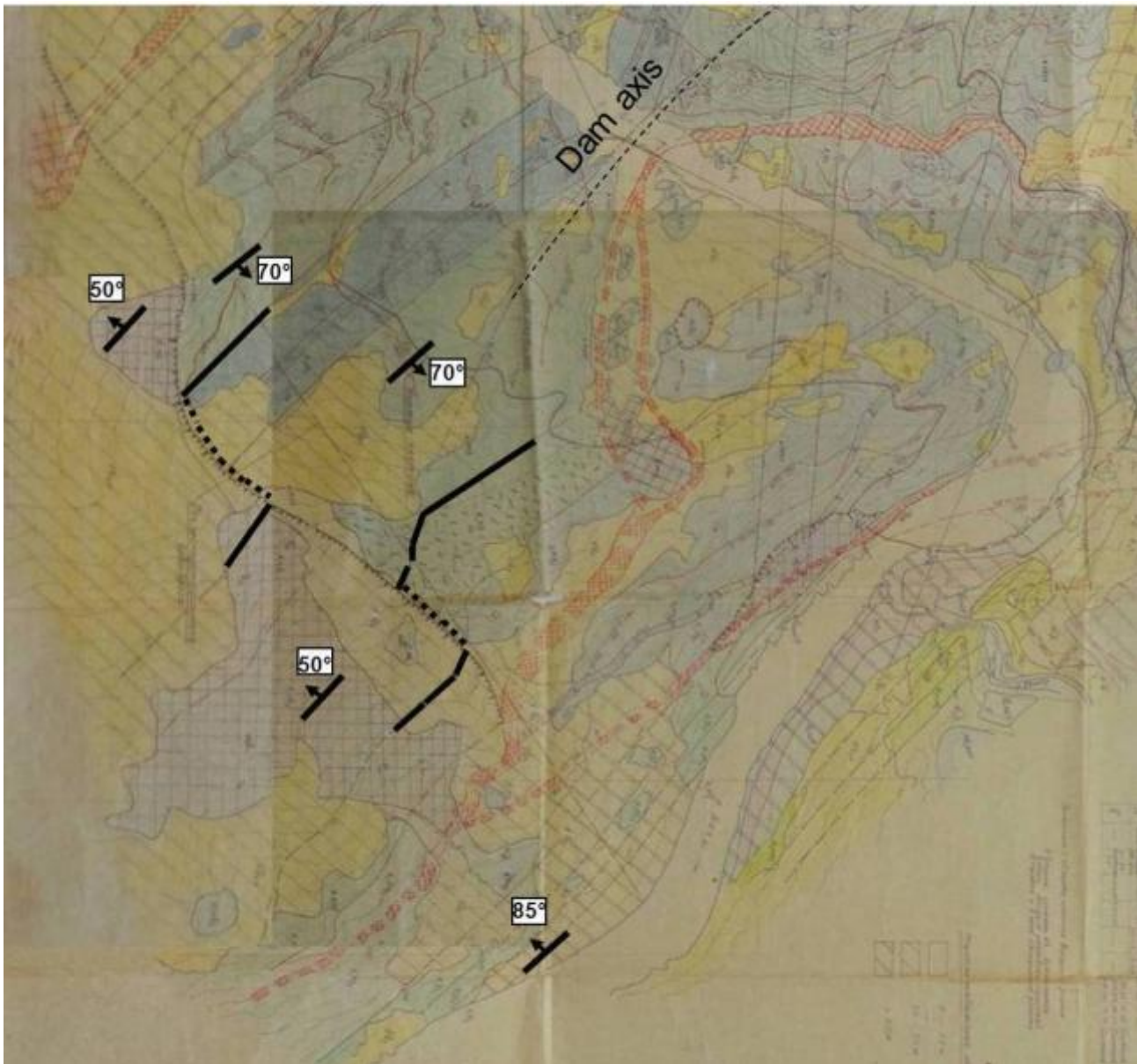
Рисунок 3. Фрагмент из геологического отчета 1978 г. Расширение геологических контактов и напластований структурных позиций выделяют предполагаемые смещения и резкое изменение угла наклона напластования.
